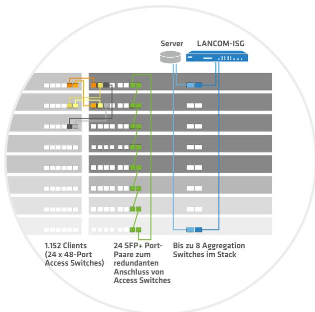
Abb. 4: Detailansicht mit bis zu acht LANCOM XS-5110F in Ring-Topologie-Stacking
