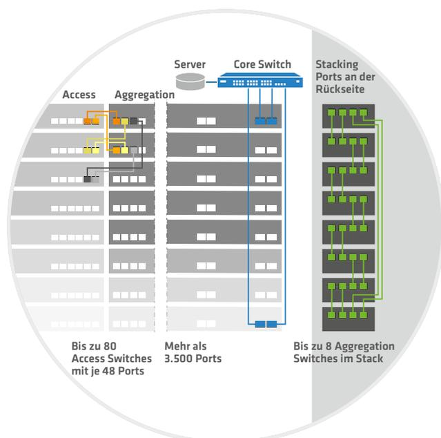
Abb. 12: Detailsicht mit bis zu acht LANCOM XS-6128QF in Ring-Topologie-Stacking
