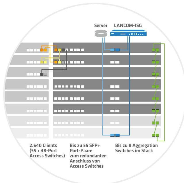
Abb. 7: Detailansicht mit bis zu acht LANCOM XS-5116QF in Ring-Topologie-Stacking
