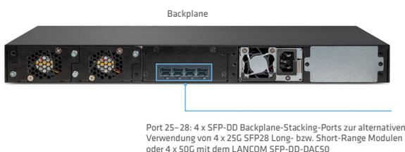
Abb. 9: Stacking-Ports-Konfiguration auf der Rückseite des LANCOM XS-6128QF (4 x 50G)
